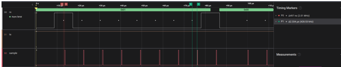
Rysunek 3.24: Próbkowanie sygnału UART
